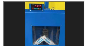
Prueba de Ruptura
